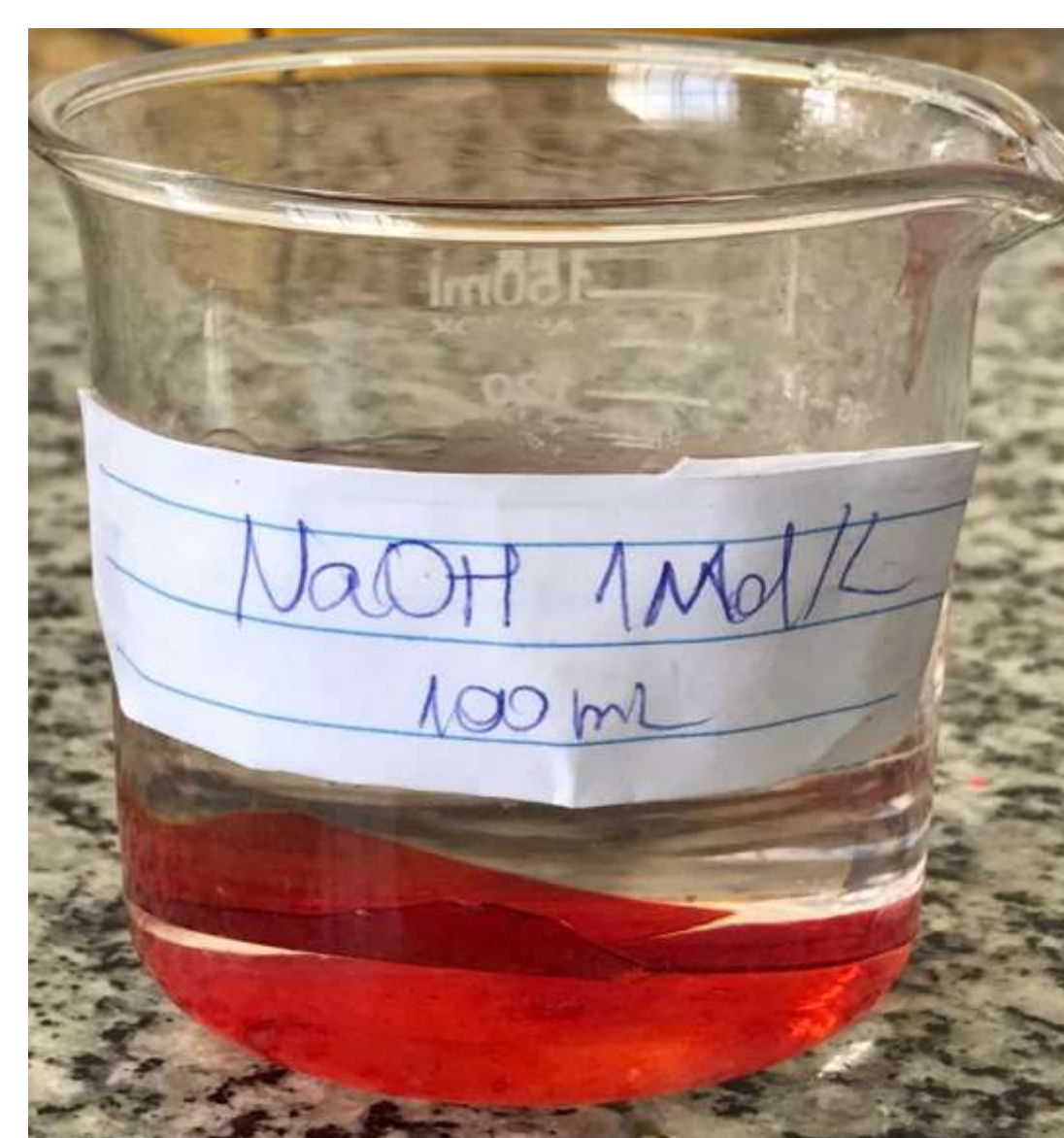
Figura 3 – Filme retirado de uma solução de NaOH 1 Molar
