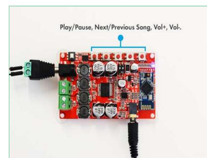
Placa de som com Bluetooth. Fonte: <https://www.filipeflop.com/blog/caixa-de-som-amplificador-de-audio-bluetooth/>
